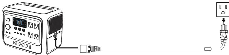
**Remarque :** ne branchez pas le câble de charge CA de l'appareil sur ses propres prises CA, car cela pourrait endommager l'appareil connecté.
