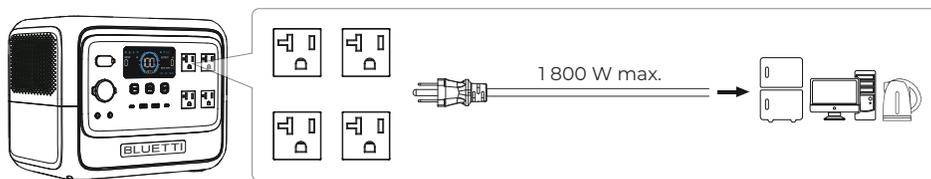
**Remarque :** Lors de l'entretien des appareils connectés à l'appareil, n'oubliez pas de les débrancher des prises. Même si la sortie CA est désactivée, il est nécessaire de débrancher physiquement les appareils pour une déconnexion complète.
