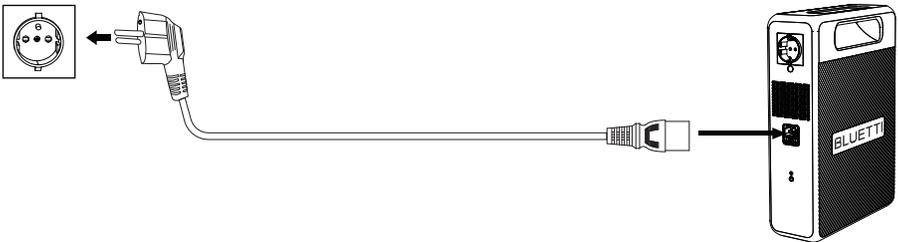
**Nota:** No conecte el cable de carga de CA de la unidad a sus propias tomas de corriente de CA. Si lo hace, el dispositivo conectado podría resultar dañado.
